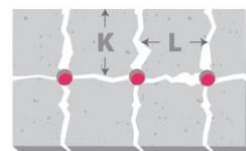
Duży rozstaw: L \geq k rysa główna i rysy prostopadłe
